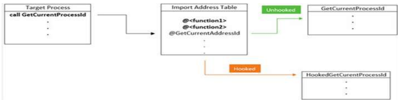
Figure 8 - Exemple d'IAT Hooking sur la fonction GetCurrentProcessId
